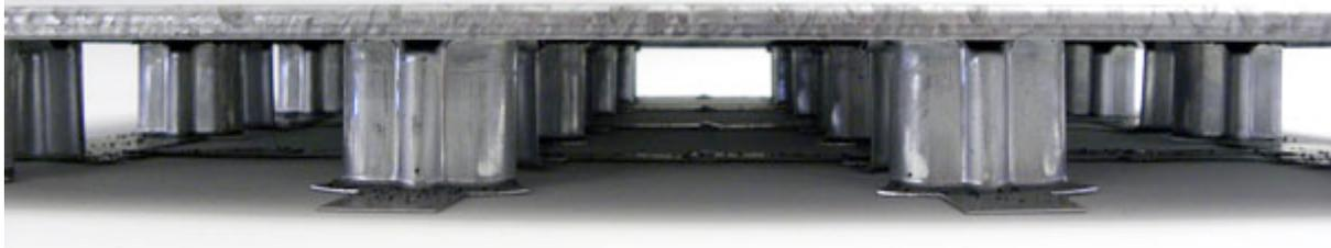
Die Sockelelemente sind 50 x 50 cm gross in fünf verschiedenen Höhen, von 38 bis 108 mm erhältlich. Dazu gibt es Klappen, Rahmen, Einschubdosen, Verbindungsboxen und übriges Zubehör. Das niedrige Gewicht des Systems (ca. 23 kg/m<sup>2</sup>) in Verbindung mit Eigenschaften wie Festigkeit und Nichtentflammbarkeit ermöglicht es, auch historische Gebäude mit einer Flexibilität aufzuwerten, wie sie in zeitgemässen Büros verlangt wird.
