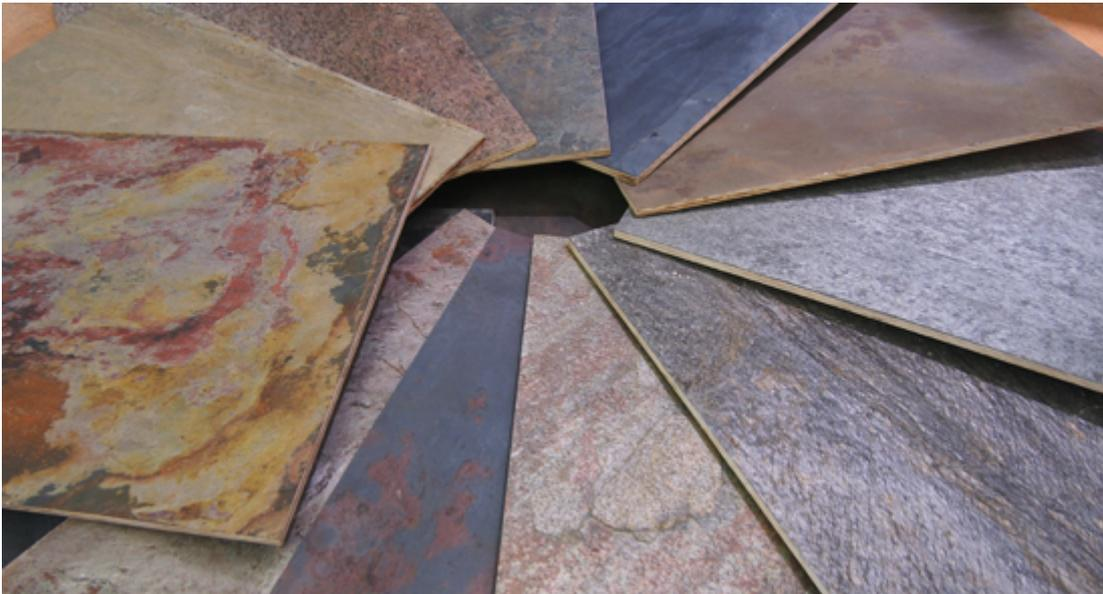
[Skinroc®](#) besteht aus einer mittels Spezial-Werkzeug abgespaltenen (=skinned) Schicht Naturschiefer oder Quarzit (=rock) und einem Träger aus Polyester mit Glasfasern und Sand um die Festigkeit und Formstabilität zu gewährleisten. Der Naturstein mit seinen Farben macht jeden Quadratzentimeter zu einem Unikat. Gelebt wird Skinroc® mittels PU oder zementös. Als Untergrund eignen sich Beton, Estrich, Keramik, Holz, Metall, Sperrholz, Fiberglas, Gips, Gipskarton und Trockenbauwände.
