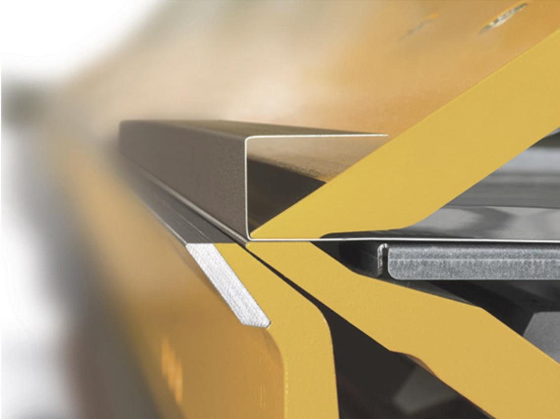
Biegemaschine zur Fälsung
